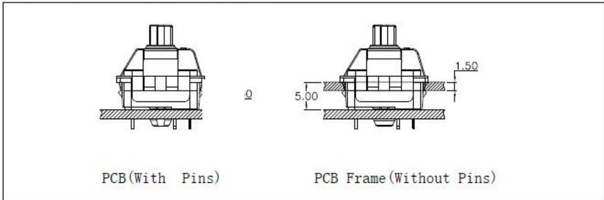
Circuit Board layouts 电路板布局
